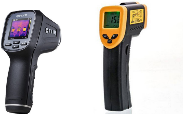
Figura 1 – (a) Dispositivo construído para medição das variáveis, (b) câmera térmica e termômetro digital laser utilizados no experimento
